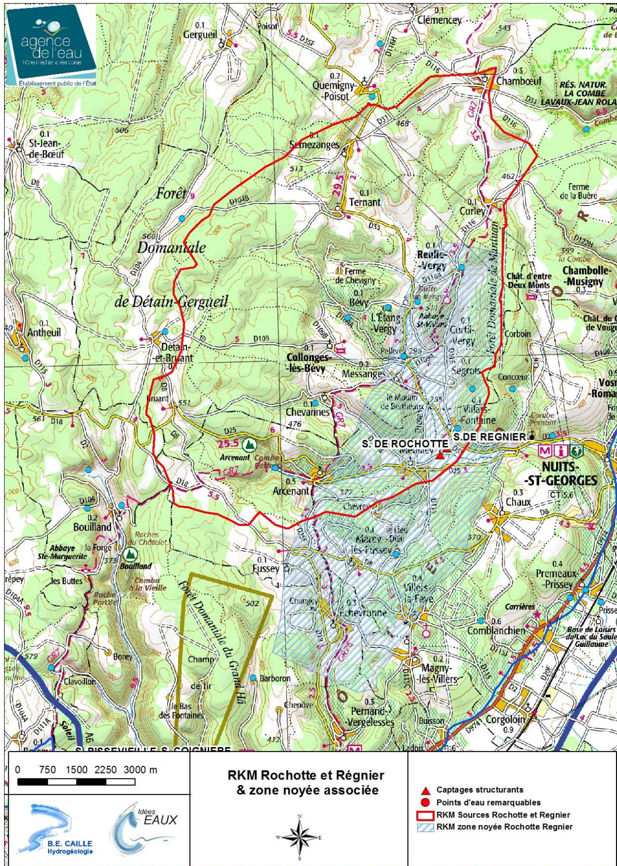
Figure 58 : RKM des sources Rochotte et Régnier et zone noyée sur carte topographique (Délimitation provisoire en attendant les conclusions de l'étude BAC qui est en cours (BE C. Caille))
